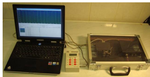
Рис. 9. Комплект приборов «Нанотестер» в составе динамической меры, источника управляемого напряжения, оптического интерферометра и компьютера.
