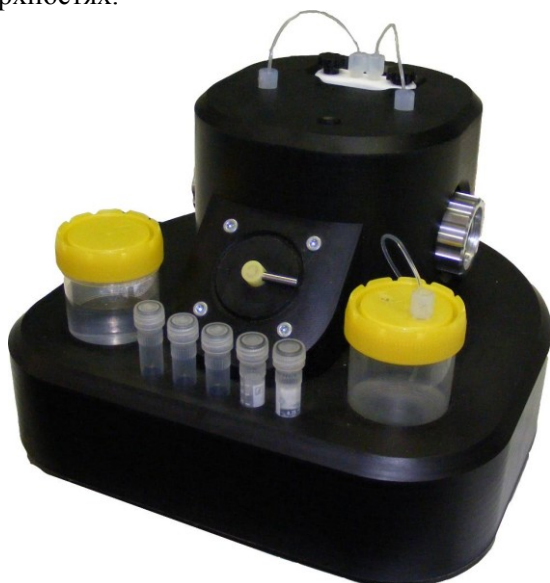
Рис. 1. Фотография наномеханической кантилеверной системы – БиоСкан.
