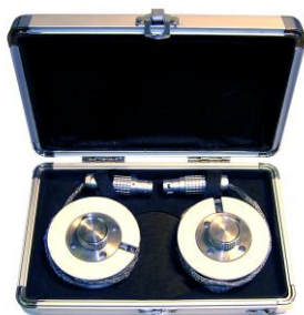
Рис. 1. Комплект динамических мер для вертикального и горизонтального перемещения с кабелями и разъемами в транспортном контейнере.
